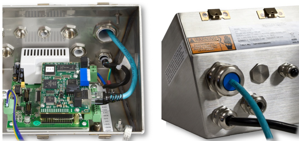
Abbildung 2-66: Ethernet-Kabelführung für das Gehäuse für raue Umgebungen
