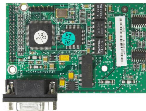
Figura 3-67: Tarjeta opcional PROFIBUS, gabinete para montaje en panel
