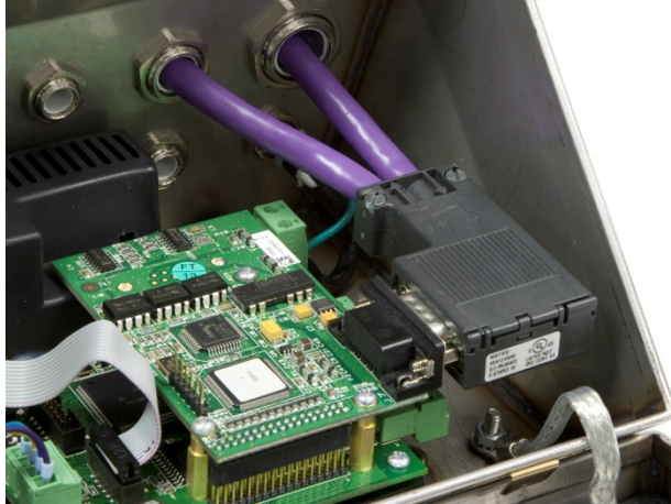
Abbildung 2-69: PROFIBUS-Kabelführung für das Gehäuse für raue Umgebungen
