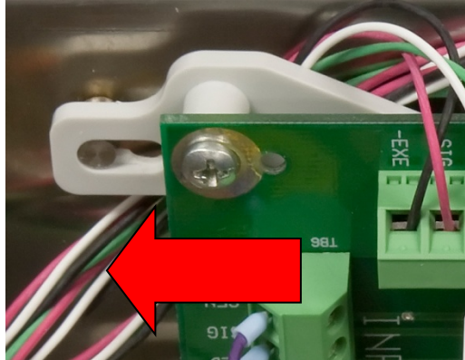
Figura 2-34: Rimozione della scheda di somma
