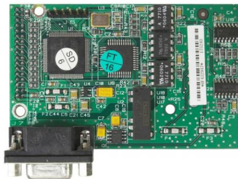
Figura 2-67: Placa opcional PROFIBUS, gabinete para montagem em painel
