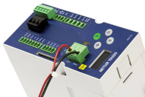
Figura 2-32: Connessione alimentazione CC
