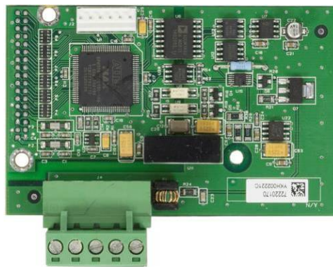
Figura 3-53: Tarjeta opcional de salida analógica
