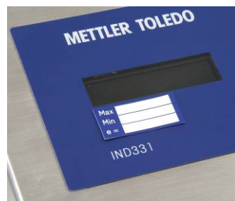
Figura 3-80: Colocación de la etiqueta de capacidad, unidad para ambientes adversos
