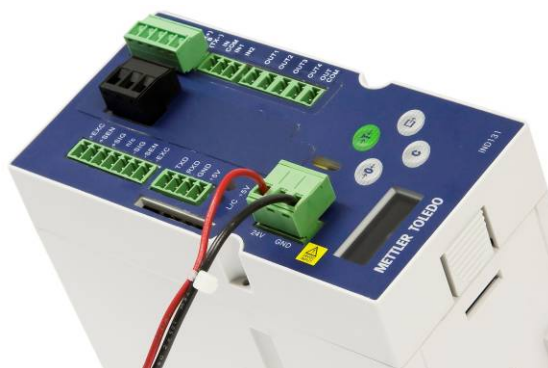
Figura 3-32: Conexión de energía de corriente directa
