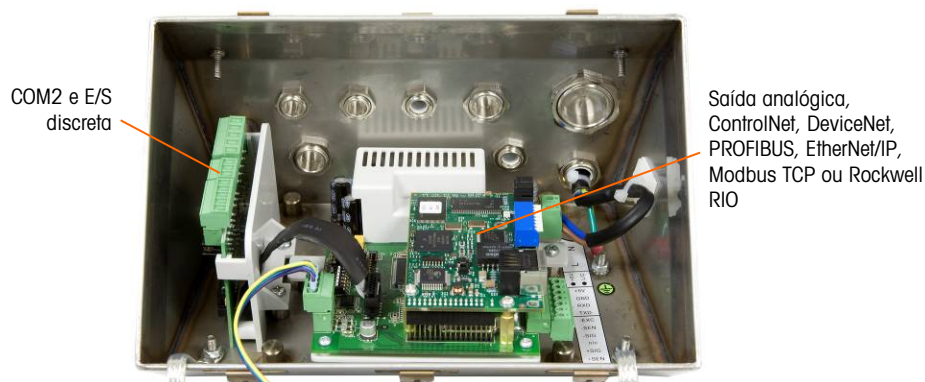
Figura 2-43: Localizações de opção de gabinete de ambiente adverso
