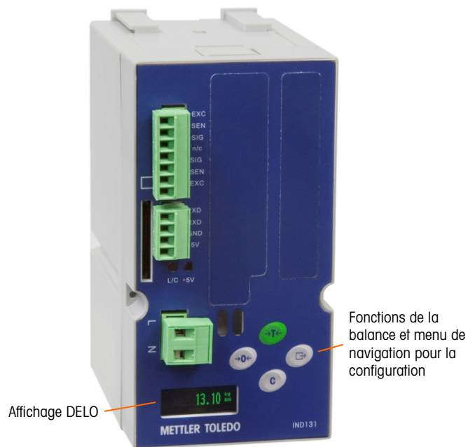
Figure 1-8: Agencement du panneau avant de l'IND131
