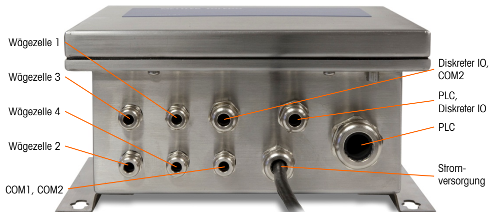
Abbildung 2-26: Kabelstutzenzuweisungen des Original Abzweigkastengehäuses
