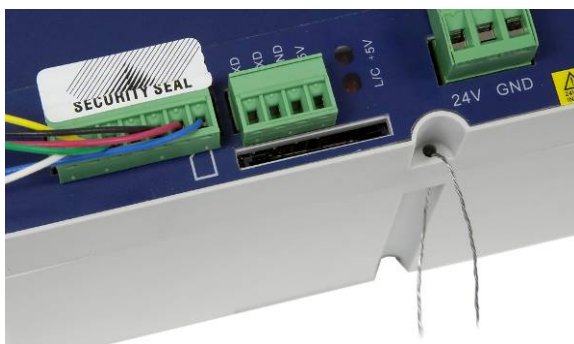
Abbildung 2-82: Versiegeln der DIN- und Schalttafelversion – Draht- und Papiersiegel
