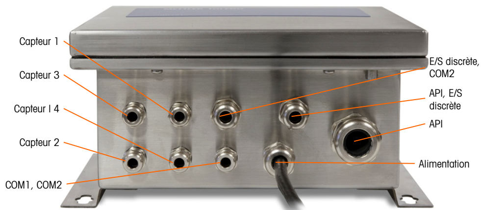
Figure 2-26 : Affectations du presse-étoupe d'un boîtier J-Box, version originale
