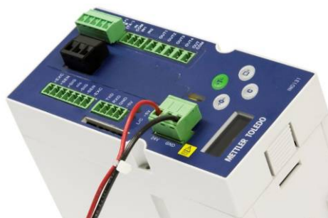
Figura 2-32: Conexão de energia CC
