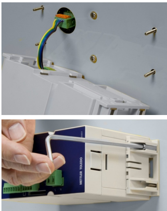
Figure 2-14: Installing DIN Module
