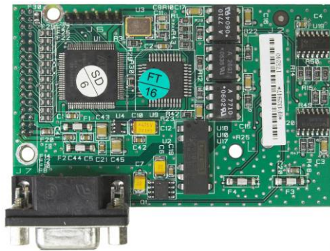
Figura 2-67: scheda opzionale PROFIBUS, armadietto con montaggio a pannello
