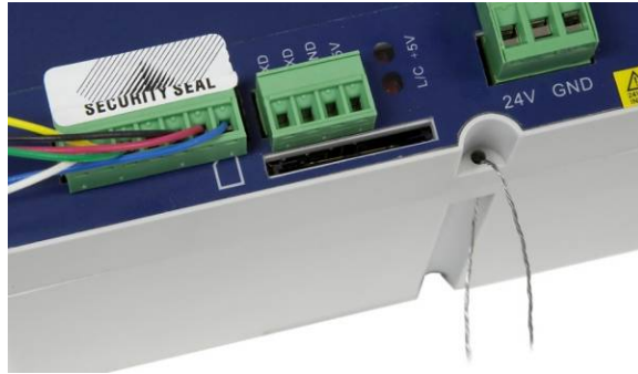
Figura 2-82: O lacre de DIN e painel de montagem – lacres de fios e papéis
