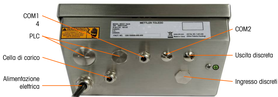
Figura 2-25: Assegnazioni dei pressacavi dell'armadietto per ambienti difficili
