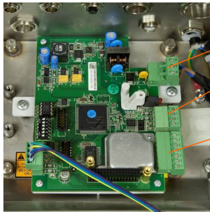
Abbildung 2-31: Anschlüsse für das Gehäuse für raue Umgebungen
