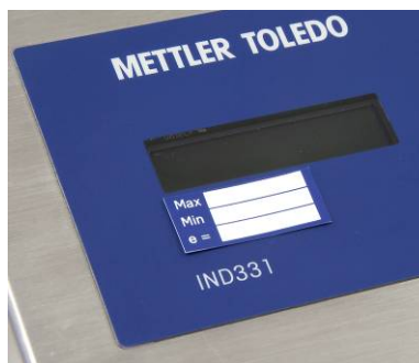
Figura 2-80: posizione dell'etichetta di capacità, unità per ambienti difficili
