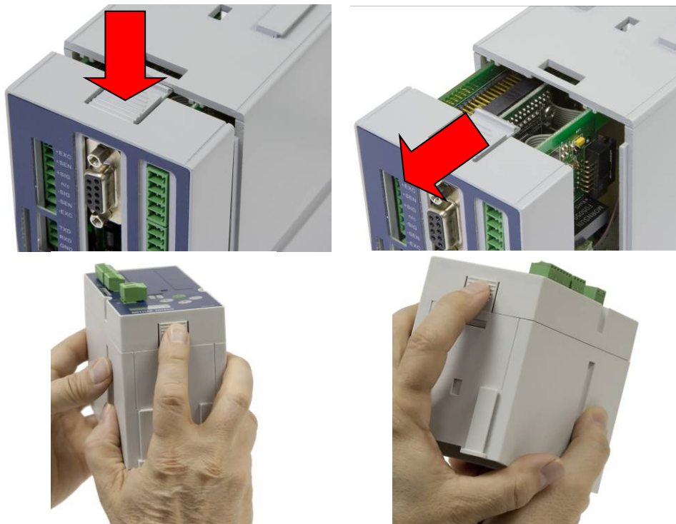
Abbildung 2-1: DIN- und Schalttafelgehäuse öffnen
