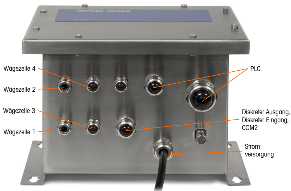
Abbildung 2-27: Kabelstutzenzuweisungen des Aktualisierte Abzweigkastengehäuses
