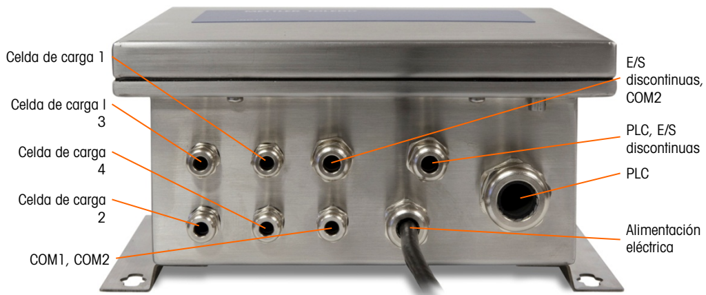
Figura 3-26: Asignaciones de casquillos en el gabinete para caja de conexiones, versión original
