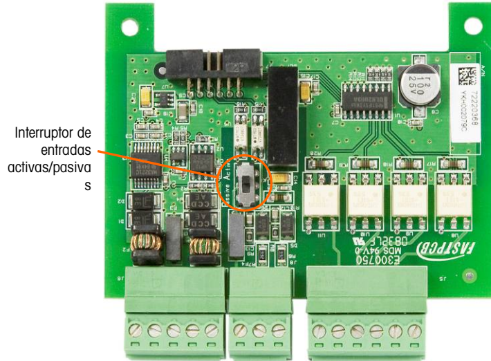
Figura 3-50: Tarjeta opcional COM2/E/S discontinuas (estado sólido)
