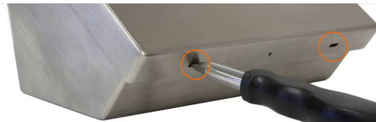
Abbildung 2-4: IND331-Gehäuse für raue Umgebungen öffnen
