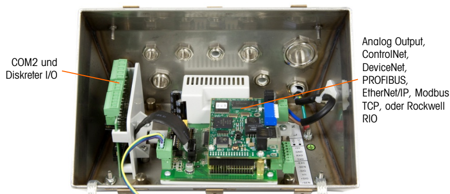
Abbildung 2-43: Optionspositionen im Gehäuse für raue Umgebungen
