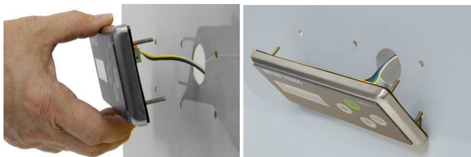
Figura 3-10: Interfase del operador de la IND331
