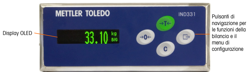
Figura 1-9: layout del pannello anteriore di IND331
