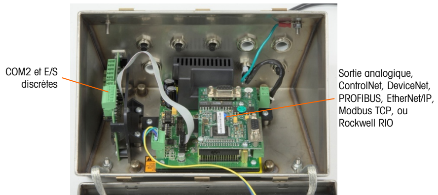
Figure 2-43 : Emplacements des options pour boîtier version environnement rude
