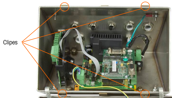
Figura 2-77: Cliques da tampa frontal do gabinete de ambiente adverso
